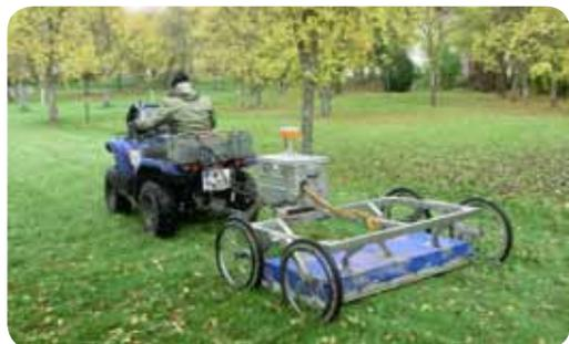
Bodenradargerät durchleuchtet den Boden
